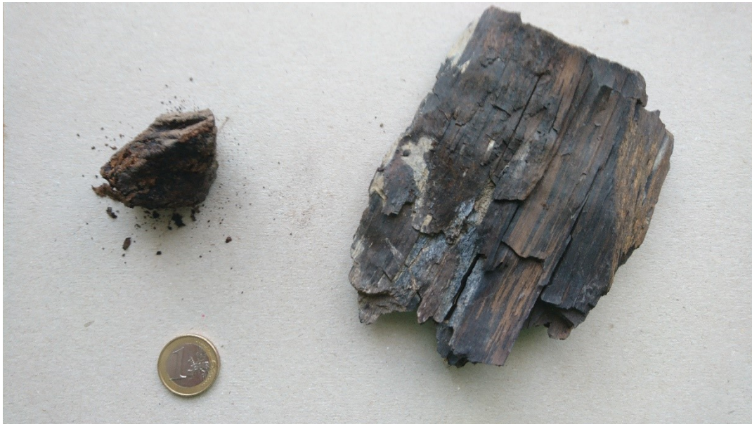
Abb. 48: Erdige Weichbraunkohle aus Zangtal (links) sowie schiefrige Weichbraunkohle aus Piberstein-Lankowitz (rechts)
