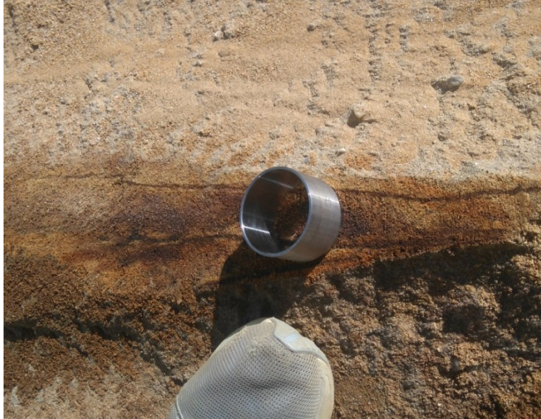
Abb. 36: Entnahme einer Stechzylinderprobe parallel zur Störung 332/80
