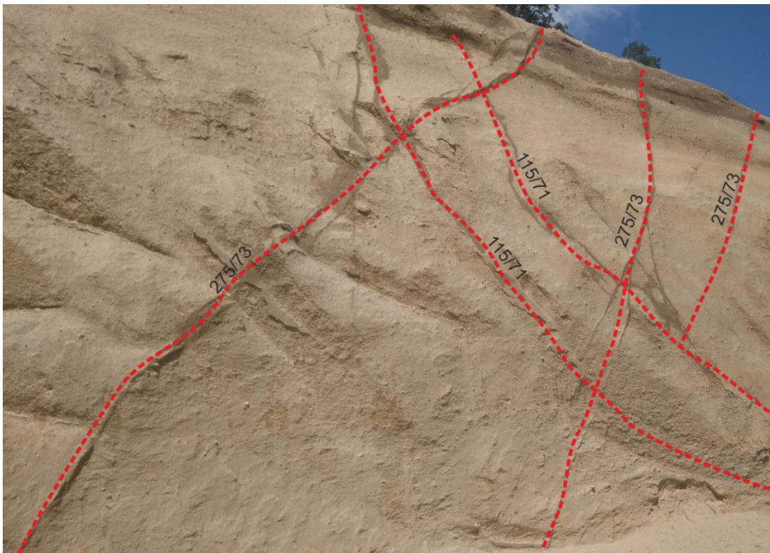
Abb. 33: Störungen im Arbeitsgebiet. Rote Linien markieren die 2 am häufigsten auftretenden Störungsrichtungen im Gebiet.
