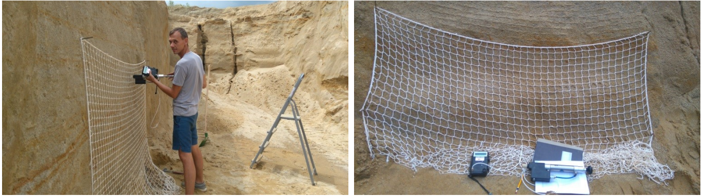
Abb. 14 Tiny Perm Messungen an einem aufgespannten Netz.
